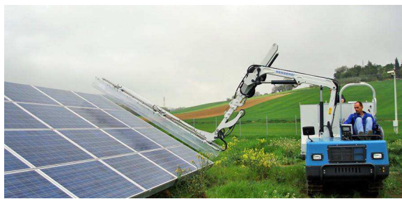
Przykładowe urządzenia wykorzystywane do mycia szklanych powierzchni modułów fotowoltaicznych
