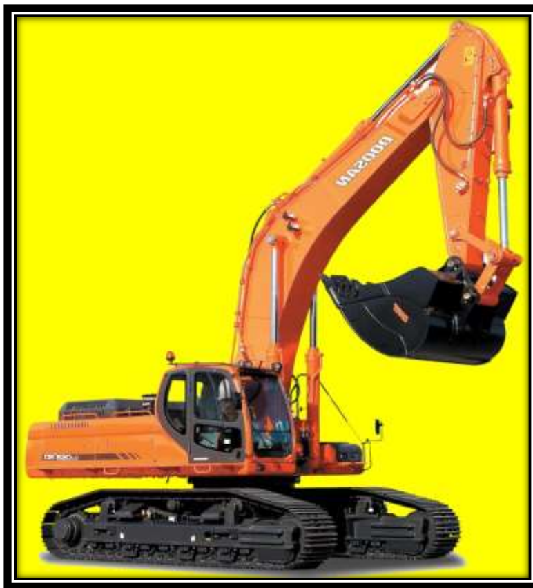
Ryc. 4. Koparka podsiębierna typu DX520LC planowana do eksploatacji na terenie kopalni
